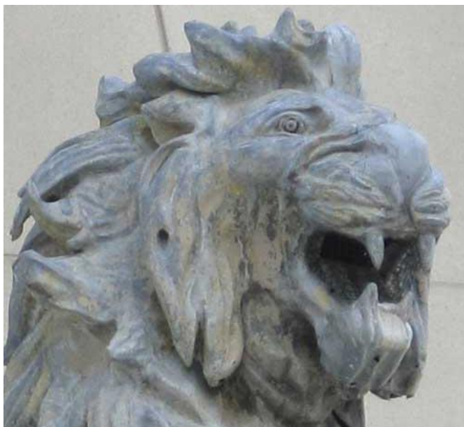
Kuva 16. Korroosiota sinkkipatsaassa. (Exhibitions: Steinberg Family Sculpture Garden, 2014)
