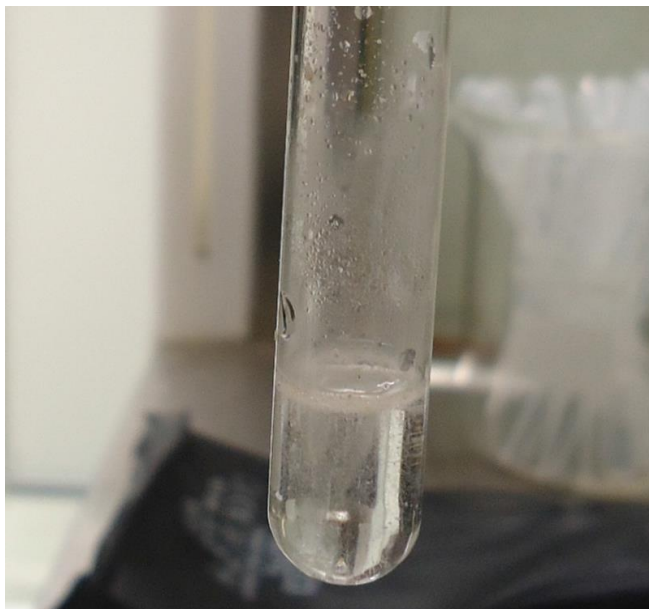
Kuva 20. Kalsiumkarbonaattitesti laimealla suolahappoliuoksella. (Ilmonen, 2014)
