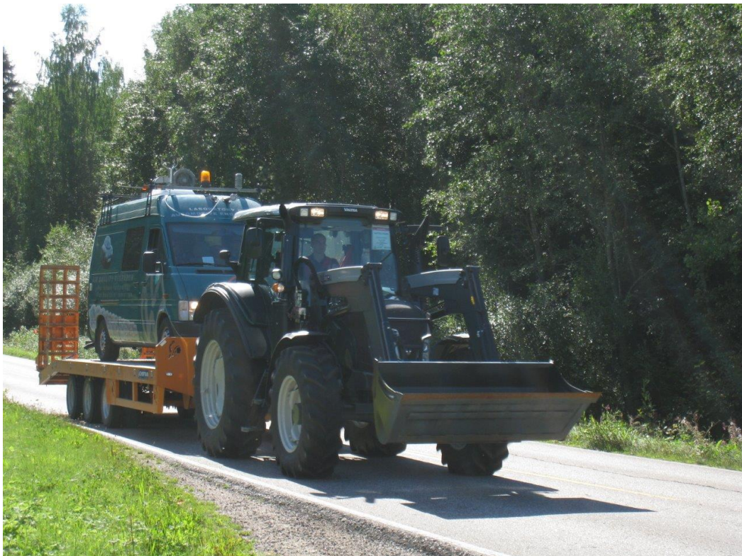
Kuva 1 Päästömittaus auto Nuuskija lavetilla mitattavan traktorin takana
