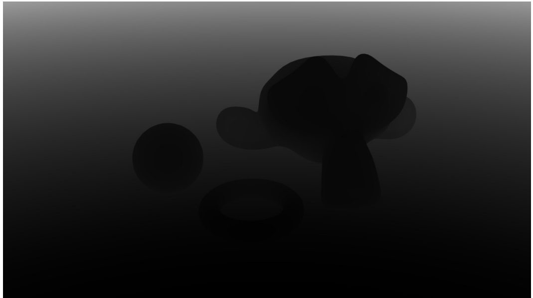
KUVIO 9. Blenderin Mist Pass muokkaamattomana. Mitä tummempi luminanssi arvo sitä lähempänä kameraa pikseli on.
