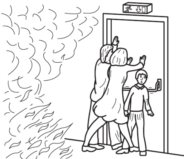
Kuva 5. Paniikkipuomin toimintaperiaate (SFS-EN 1125 2008, 6).
