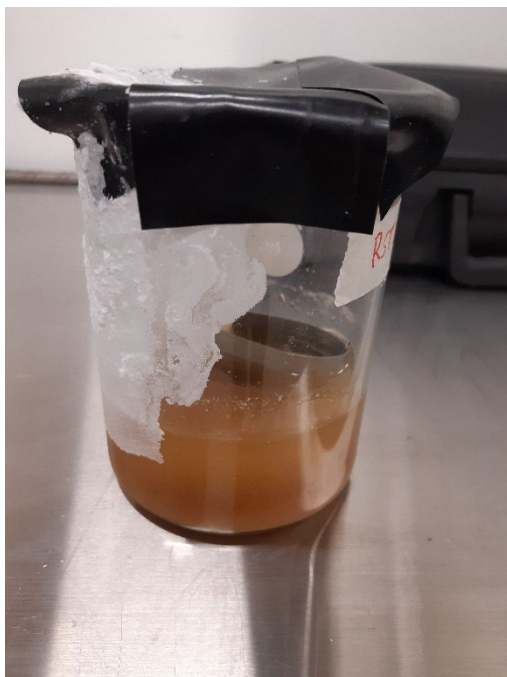
KUVA 7. Sinkitty rakenneteräs ja RST galvaanisena parina suolaliuoksessa (Lipponen 2021)
