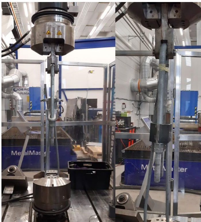
KUVA 19. Uusi ja vanha kiilakiristin kuormituskehässä (Lipponen 2021)
