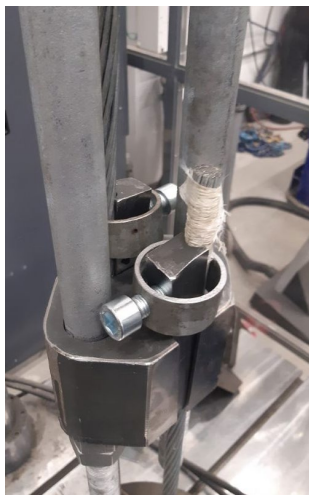
KUVA 20. Teräsversio kuormituskehässä lukitusmekanismin kanssa (Lipponen 2021)
