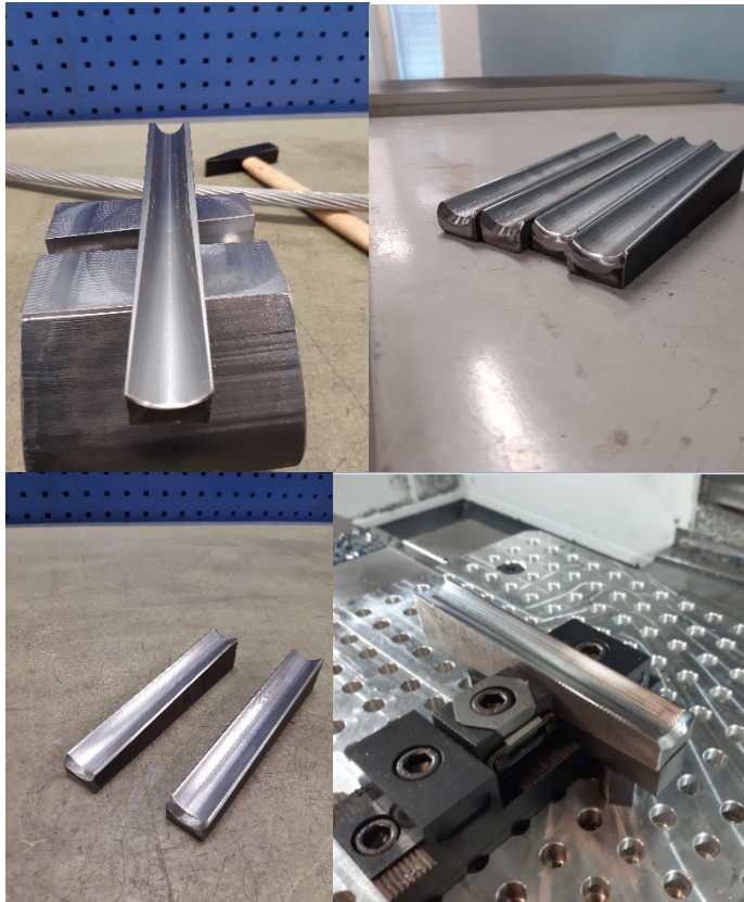
KUVA 22. Kiilan iteraatioita projektin eri vaiheissa (Lipponen 2021)
