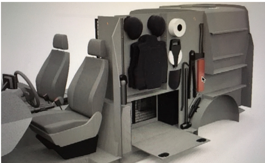
Kuva 6: Taktisten varusteiden sijoittaminen auton sivulle. (Kuva: Kaarle Mänty)
