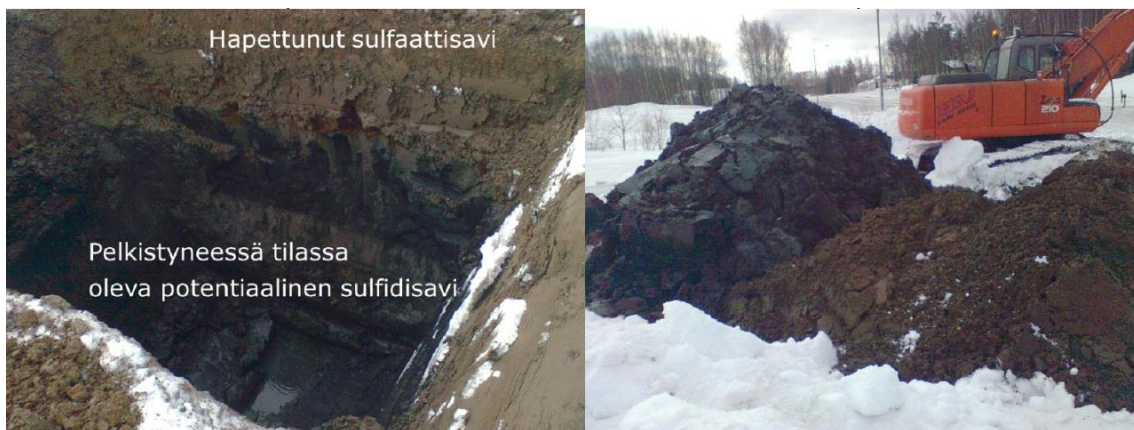
KUVA 12. Vasemmallä musta potentiaalinen hapan sulfaattimaa syvällä kuopassa. Oikealla kuvassa potentiaalista mustaa hapanta sulfaattimaa vasemmallä ja ruskeaksi muuttunutta todellista hapanta sulfaattimaa oikealla (Ramboll Oy 2014)
