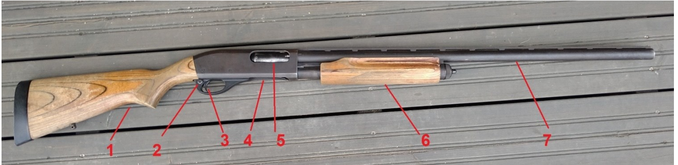
Kuva 6. Pumppuhaulikko (Kuva: Joni Jääskeläinen)
