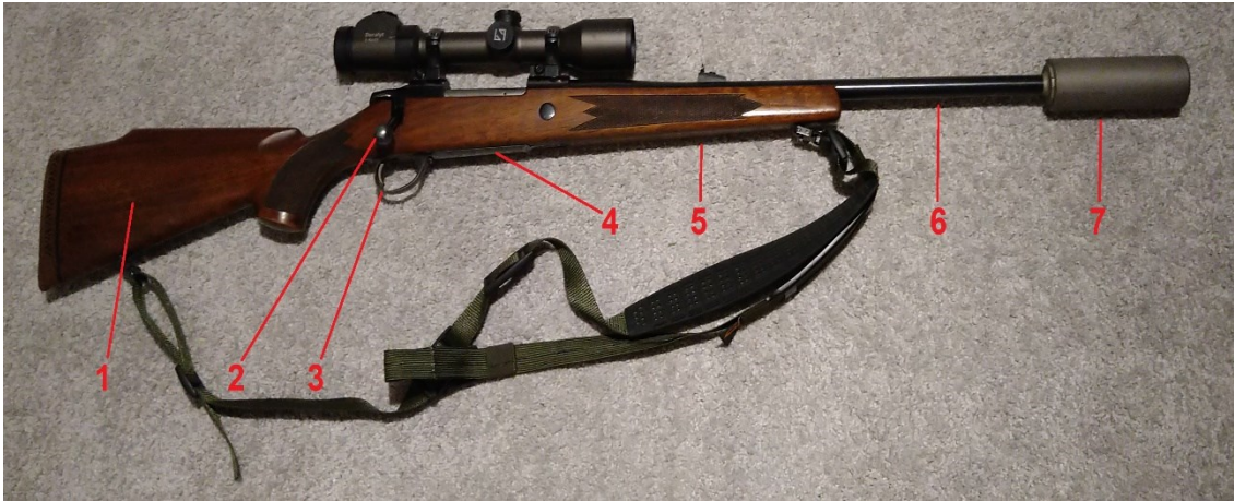
Kuva 1. Pulttilukkoinen lippaallinen kertatuli 338 Winmag kivääri, jonka päällä kiikaritähäin (ei aseosa) (Kuva: Joni Jääskeläinen)
