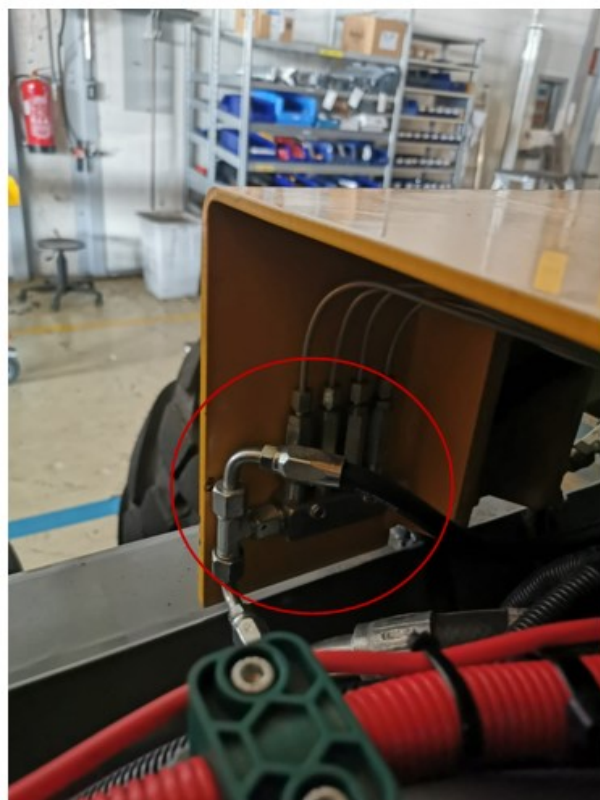
Kuva 16. Ohjaamonpyörityslaakerin annostinryhmä sijoitettiin ohjaamolevyn sisäpuolelle (Kivinen 2021).
