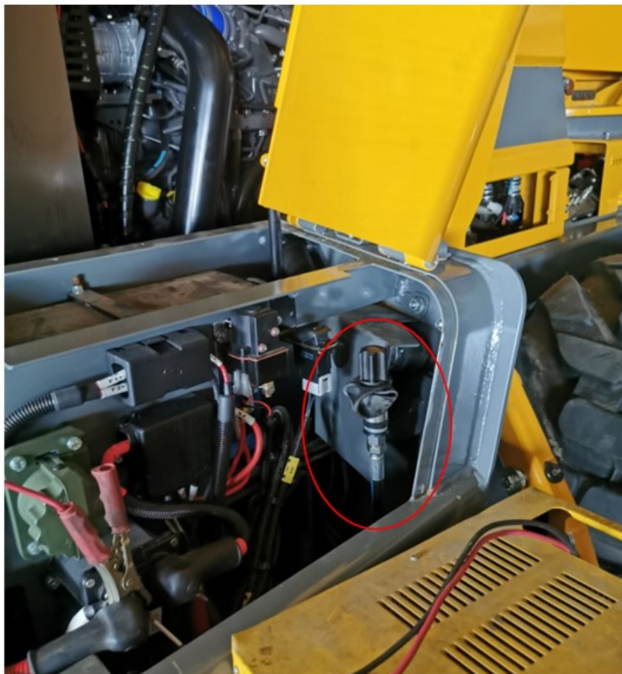
Kuva 17. Pumppausyksikön täyttöliitin on sijoitettu koneen etuluukun sisään (Kivinen 2021).
