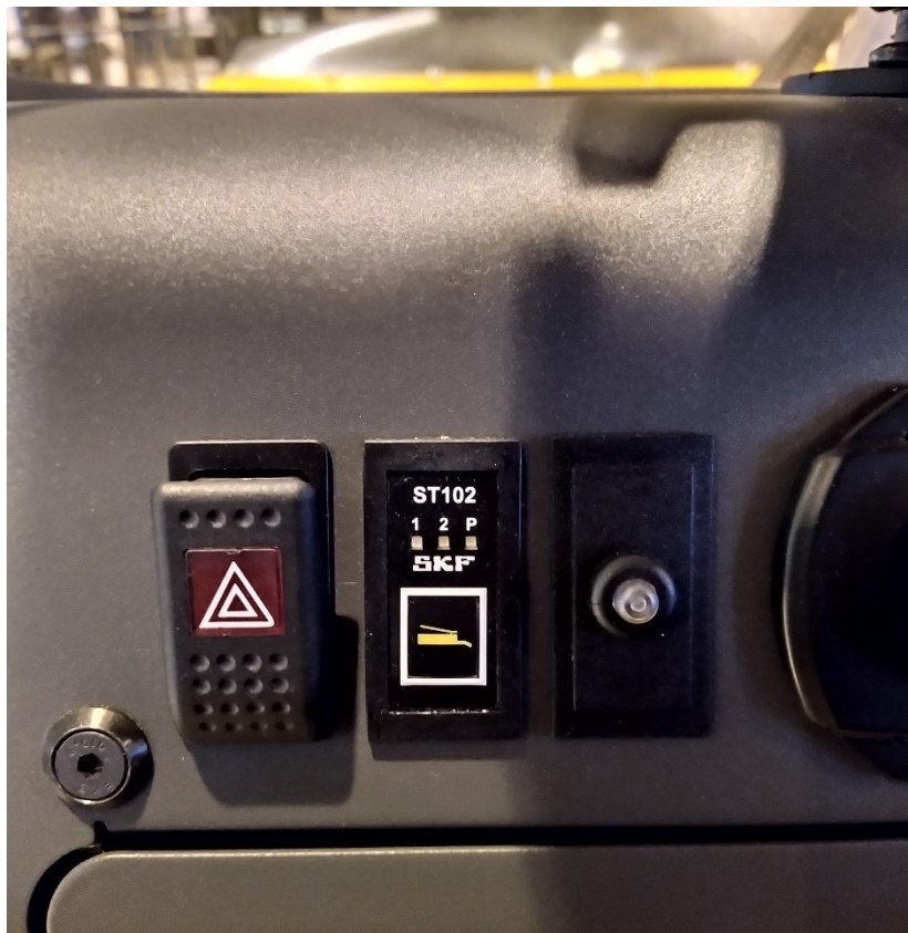
Kuva 11. FR68 kuormatraktorin kojetauluun asennettu ST102 ohjausyksikön käyttöliittymä (Kivinen 2021).
