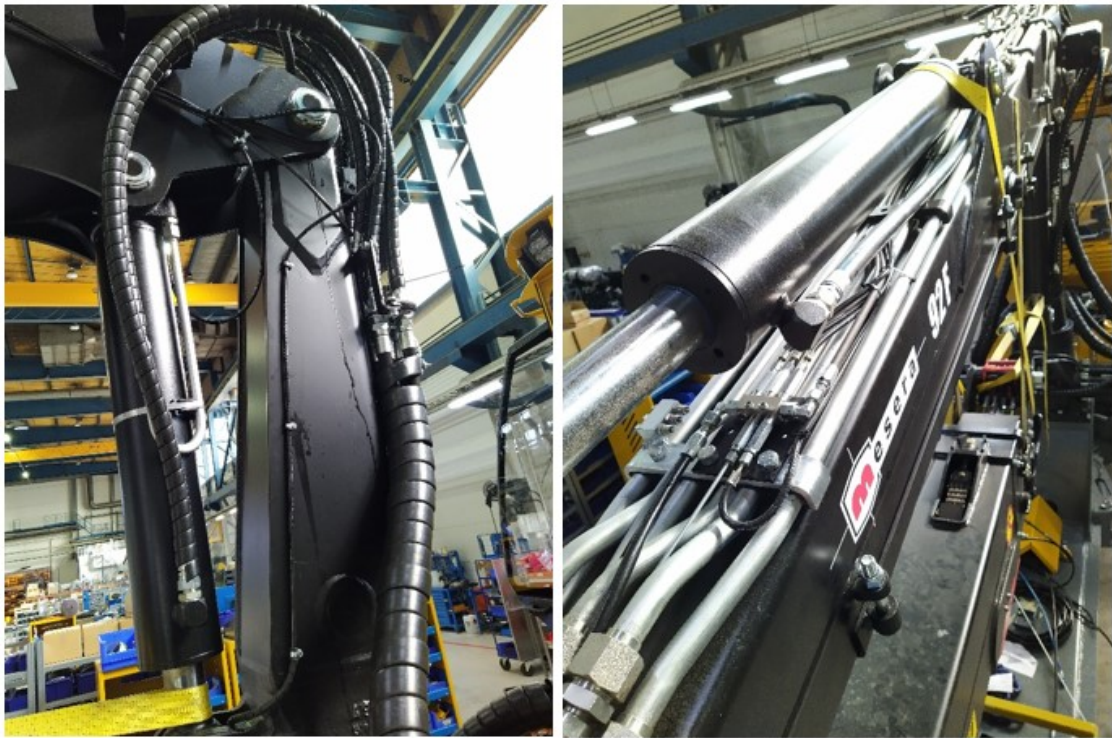
Kuva 12. Nosturin niveliin meneviä rasvaletkuja (vas.) ja puomin päällä annostinryhmä (oik.) (Kivinen 2021).
