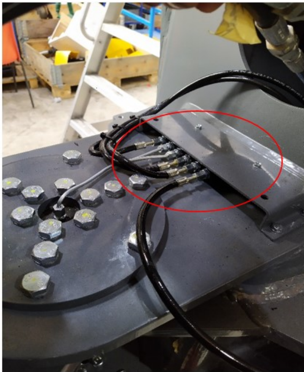
Kuva 14. Annostinryhmä (kuvassa ympyröityinä) suojattuna runkonivelen päällä (Kivinen 2021).
