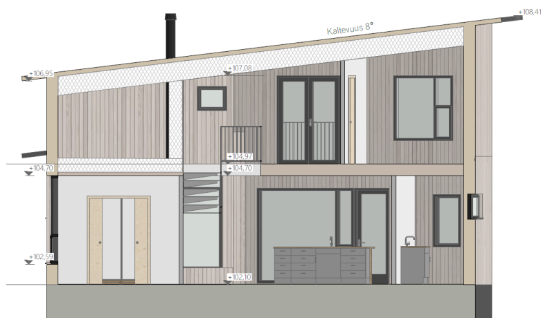
Kuva 18. Leikkauskuva rakennuksesta ruokailutilan kohdalta (Kokko 2022)
