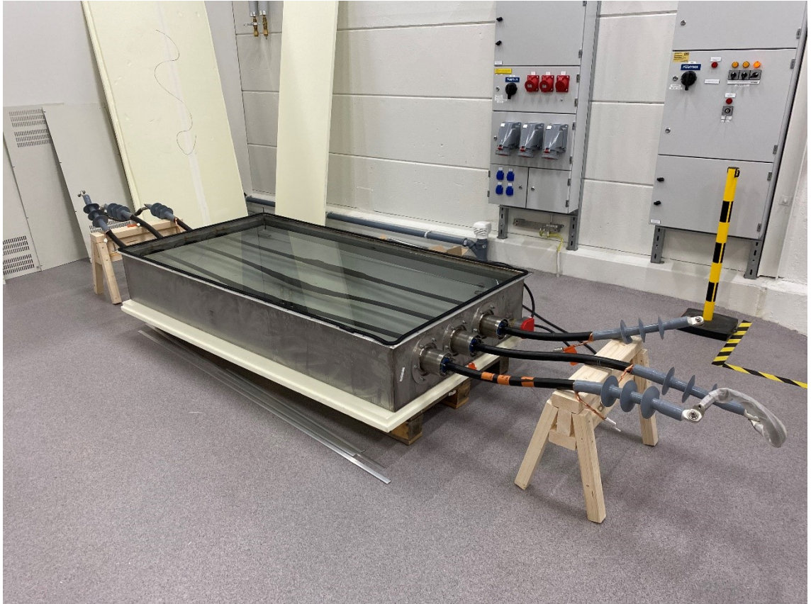
Kuva 17. Läpivientien tiiveyden koestaminen ennen lämmitystä.
