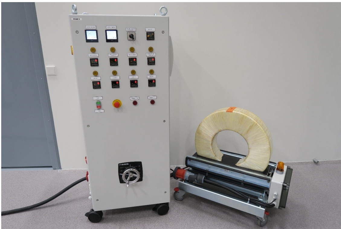
Kuva 14. Lämmitysmuuntaja ja säätömuuntaja.
