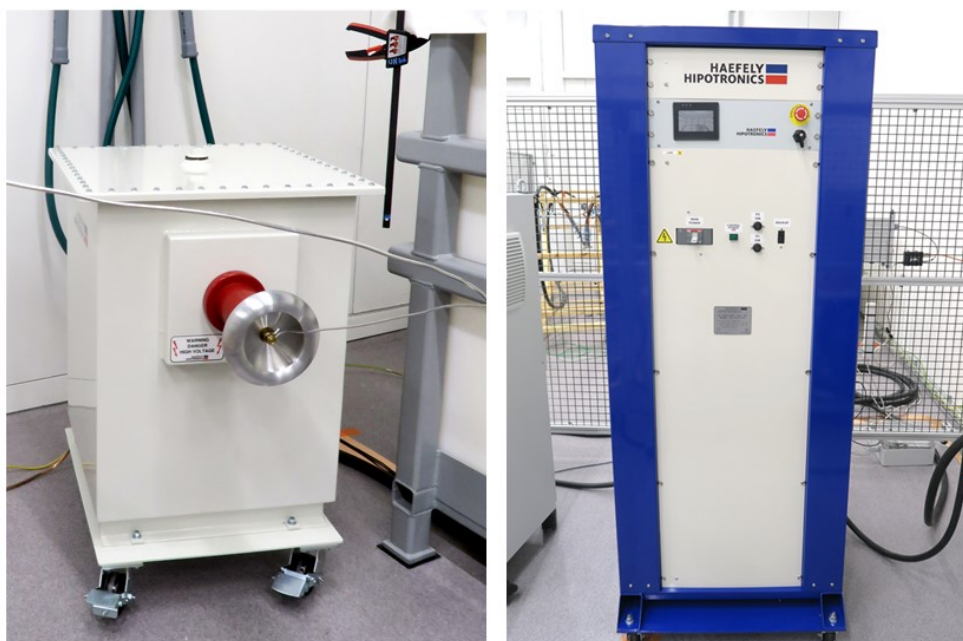
Kuva 13. Haefely Hipotronics 60 kV:n testilaitteisto.
