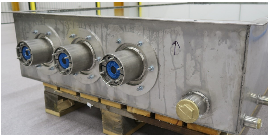
Kuva 11. Kaapeliläpiviennit vesitankkiin asennettuna.
