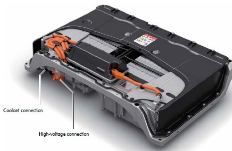
KUVA 10: Korkeajänniteakku AX2 (Volkswagen AG, 2014b)
