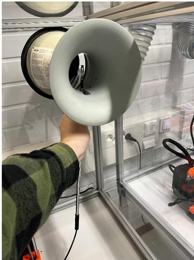
Kuva 9. Kotelon ilmanpoiston mittausperiaate AM-300 apulaitteella
