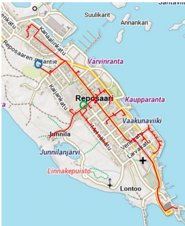
Kuva 12. Reposaaren kaukolämpöverkko. (UTG-sovellus, 2022)
