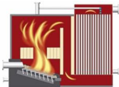
Kuva 15. Hakekattilan arinaportaavat ja palaminen. (Calortec, 2022)
