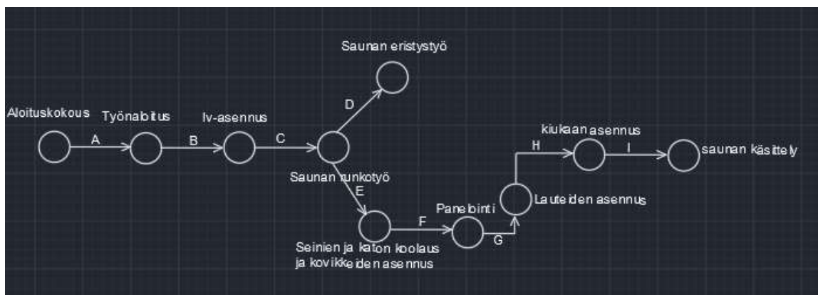
KUVA 7. Saunan rakentamisen työvaiheet (Tolonen 2022)
