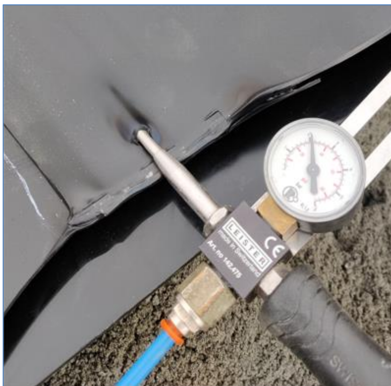
Kuva 21. Kuumakiilasauman painekoe meneillään.
