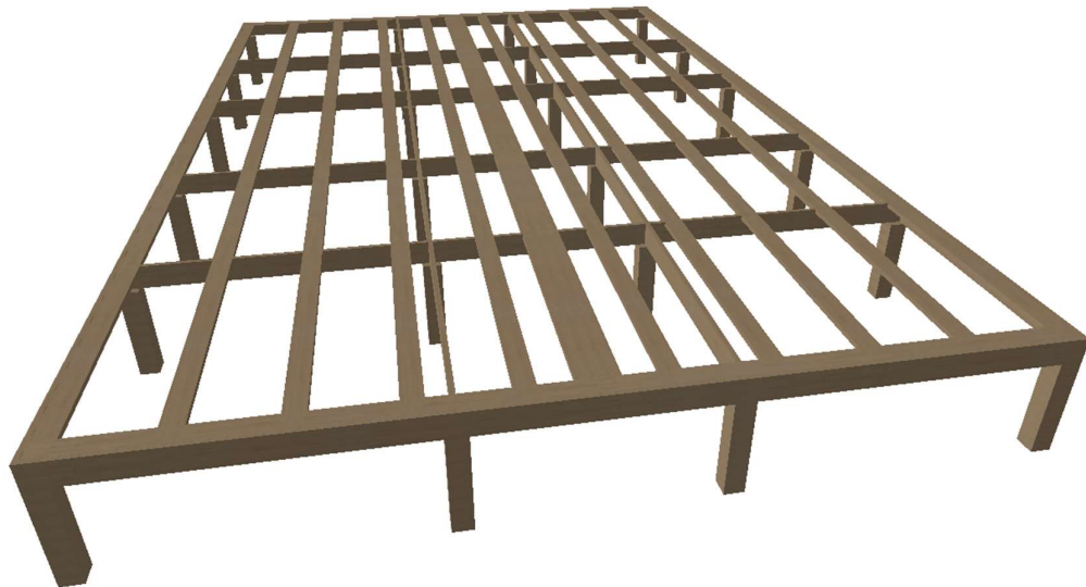
KUVA 18. Alapohjan kantava runko
