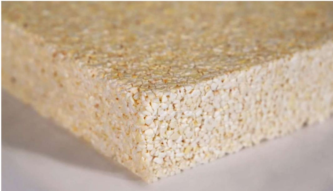
KUVA 5. Popcornista valmistettu vahto toimii eristeenä (33)
