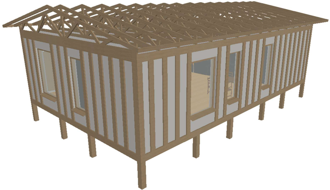
KUVA 22. Solidieristeestä valmistetut elementit ulkopuolisen rungon sisällä
