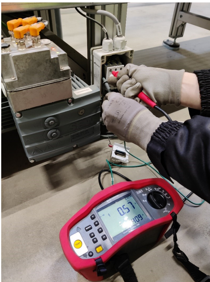
Kuva 8. Oikosulkuvirran mittaaminen kuljetinryhmän viimeiseltä turvakytkimeltä. (Lehtovirta 2022.)
