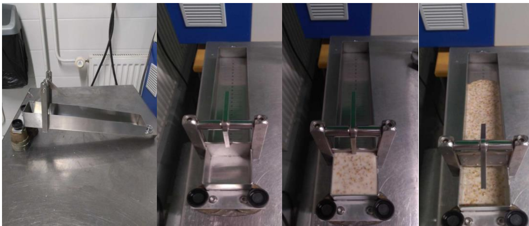
Kuva 7. Bostwick konsistometri mittausprosessi, ensimmäisessä ja toisessa kuvassa on tyhjä Bostwick laite, kolmannessa kuvassa raski näyte on asetettu kaukaloon ja neljännessä kuvassa kaukalon portti avattiin ja raski valui mittaria pitkin.
