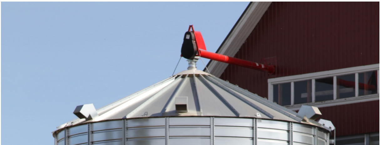
Kuva 9. Tuuletussiilon katolla olevat poistoilma tuuletuskanavat, jotka päästävät ilman ulosen kuljettua viljan läpi (Antti-Teollisuus n.d.g)
