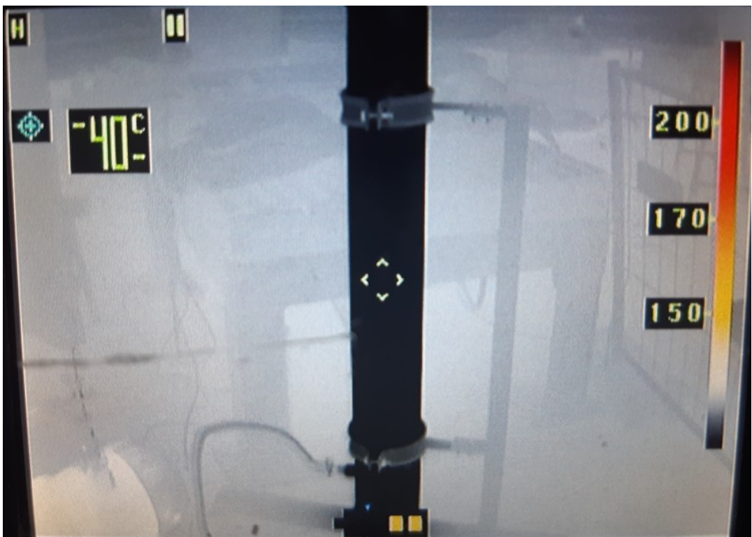
Kuva 14 Tyhjiön vapauttamisen jälkeen kappale oli kauttaaltaan jäässä
