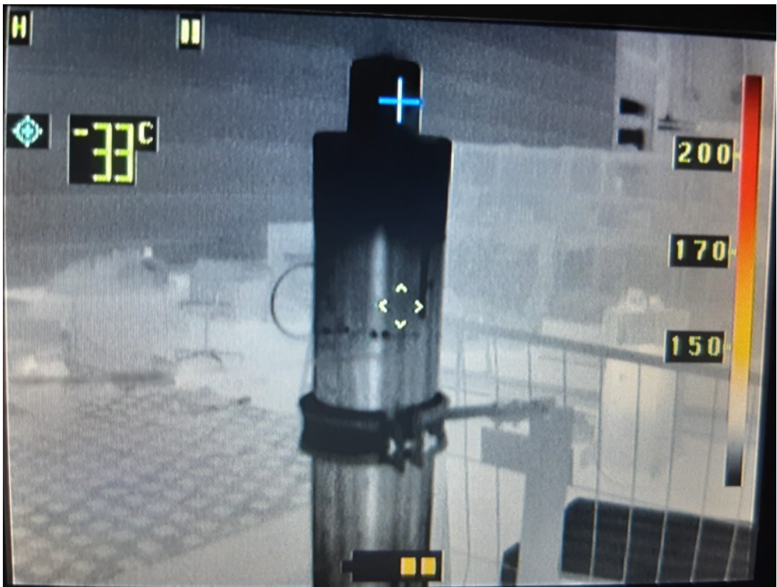
Kuva 12 Tyhjiöeristetyn kappaleen kylmin kohta näkyy kuvassa sinisellä merkillä
