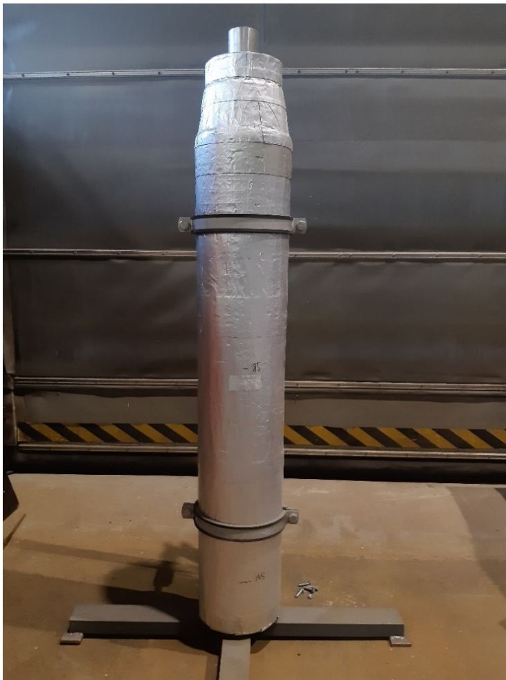
Kuva 7 Cryogel® Z -lämpöeristetty koekappale
