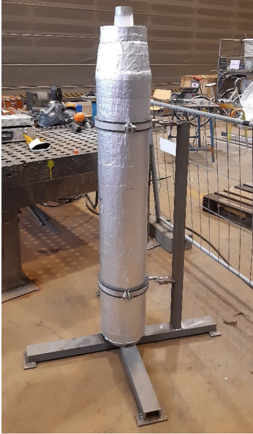
Kuva 9 Cryogel® Z -eristetty putki kokeen aikana
