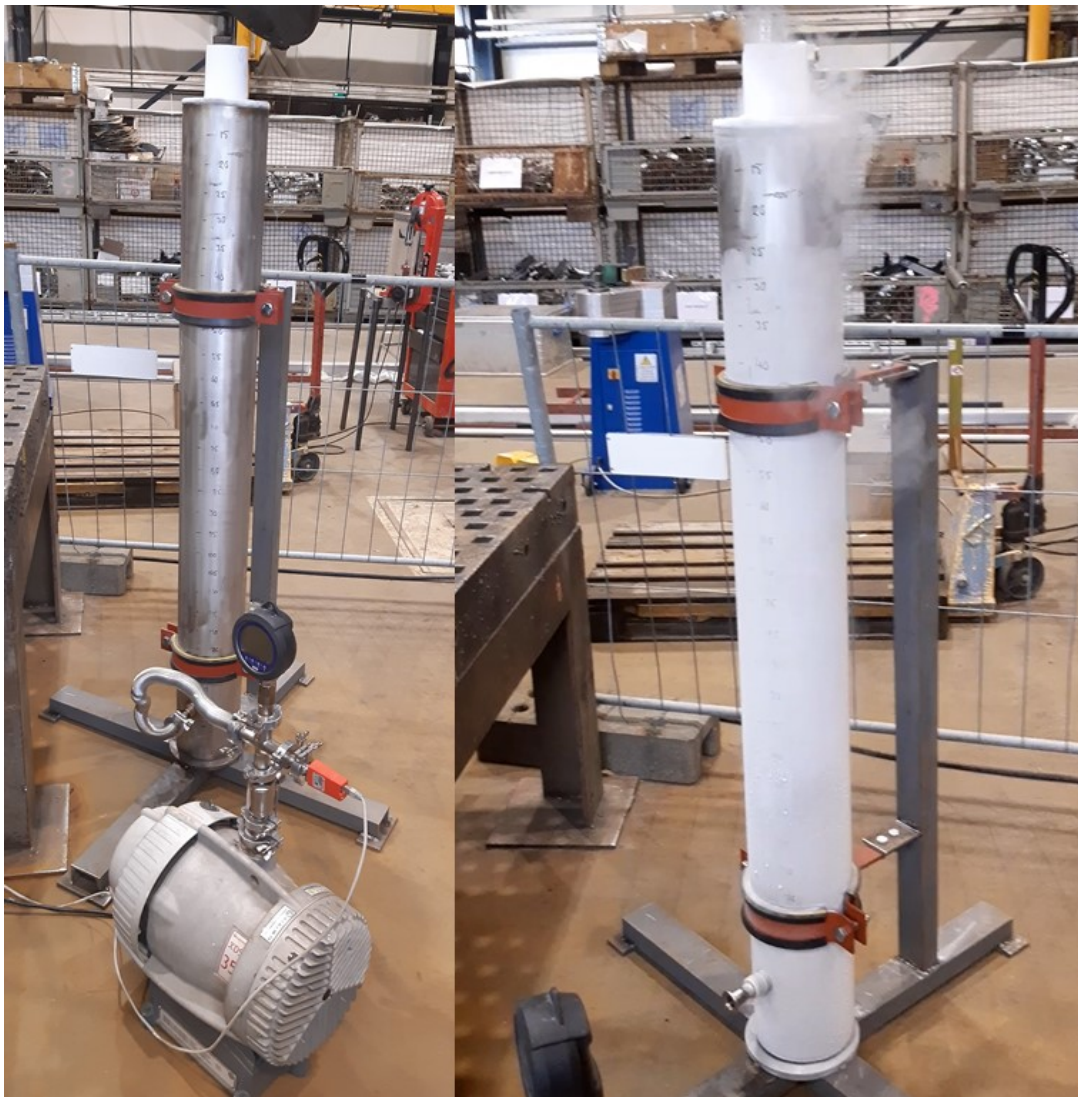
Kuva 8 Tyhjiöeristetty putki. Vasen kuva kokeen aikana ja oikea 25 minuuttia tyhjiön vapauttamisen jälkeen
