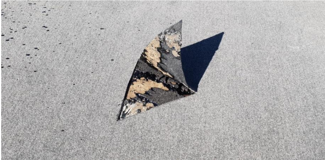
Kuva 18. Pohjakermille suoritettu kolmioviiltokoe. (Vaimare, 2021)
