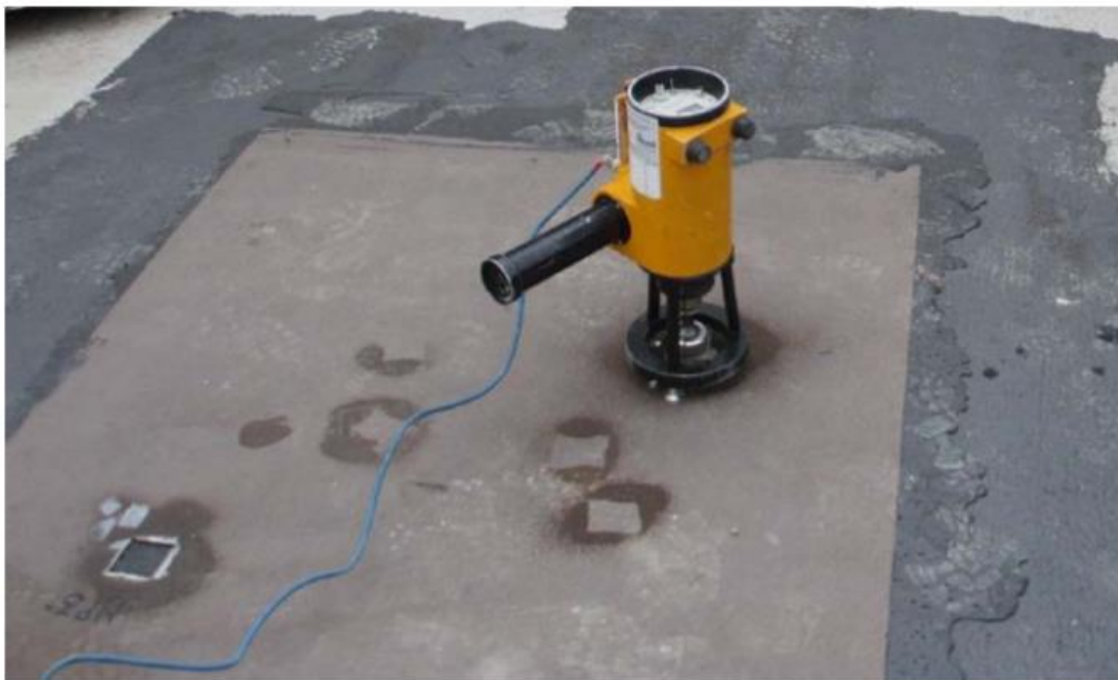
Kuva 19. Pohjakermin vetokoe (RT 103277, Liikennöidyn tason vedeneristykset, 19)
