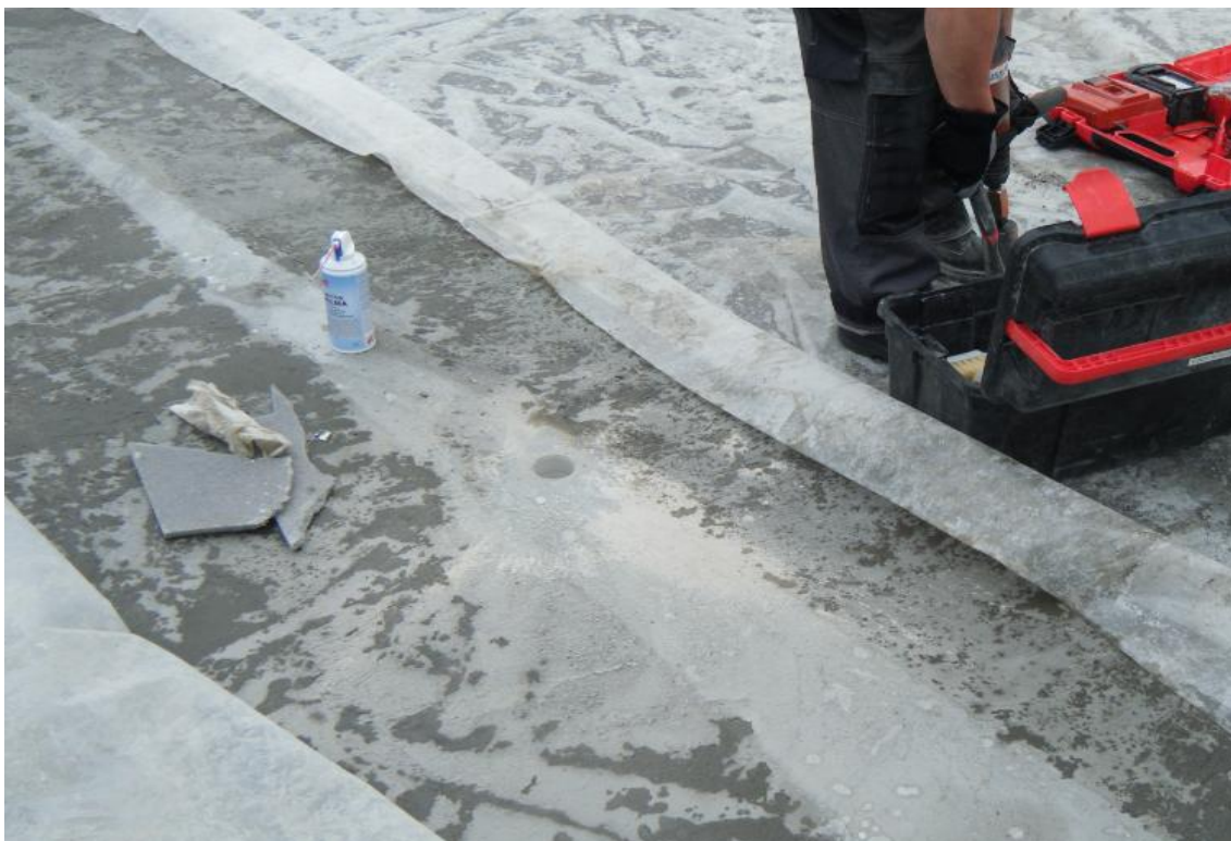
KUVA 6. Näytteenottoa kuivuvasta muotovalusta (Kuva: Toni Gussander)
