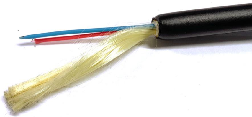
Kuva 9. Kahdesta toisiopäällysteisestä tiukkapuskuroidusta kuidusta koostuva aramidivahvisteinen valokuitukaapeli.
