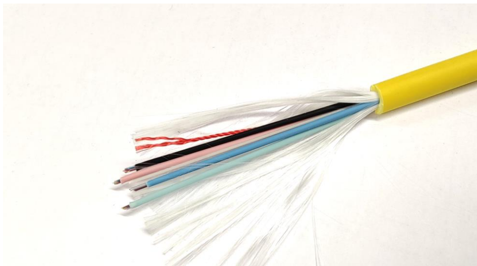
Kuva 10. Jyrsijäsuojattu valokuitukaapeli, jossa punainen aukirepäisylanka. Rakenteena neljä kuivaa väljästi kerrattua 12 kuituista kaapelia lasikuitutangon ympärillä.
