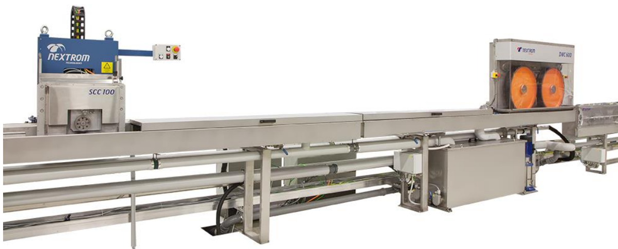
Kuva 14. Jäähdytysjärjestelmä CS4, jonka päällä ovat vetolaitteet SCC ja DWC.
