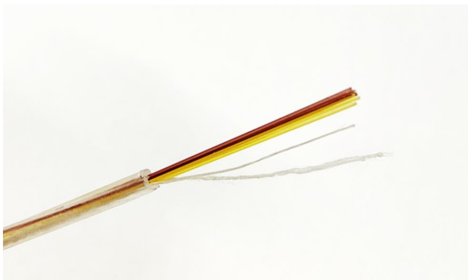
Kuva 7. Kerrattu väljä toisiopäällysteputki, jossa 12 kpl yksimuotokuituja, sekä kaksi täytelankaa. Ulkohalkaisija 2,1 mm, sisähalkaisija 1,7 mm.
