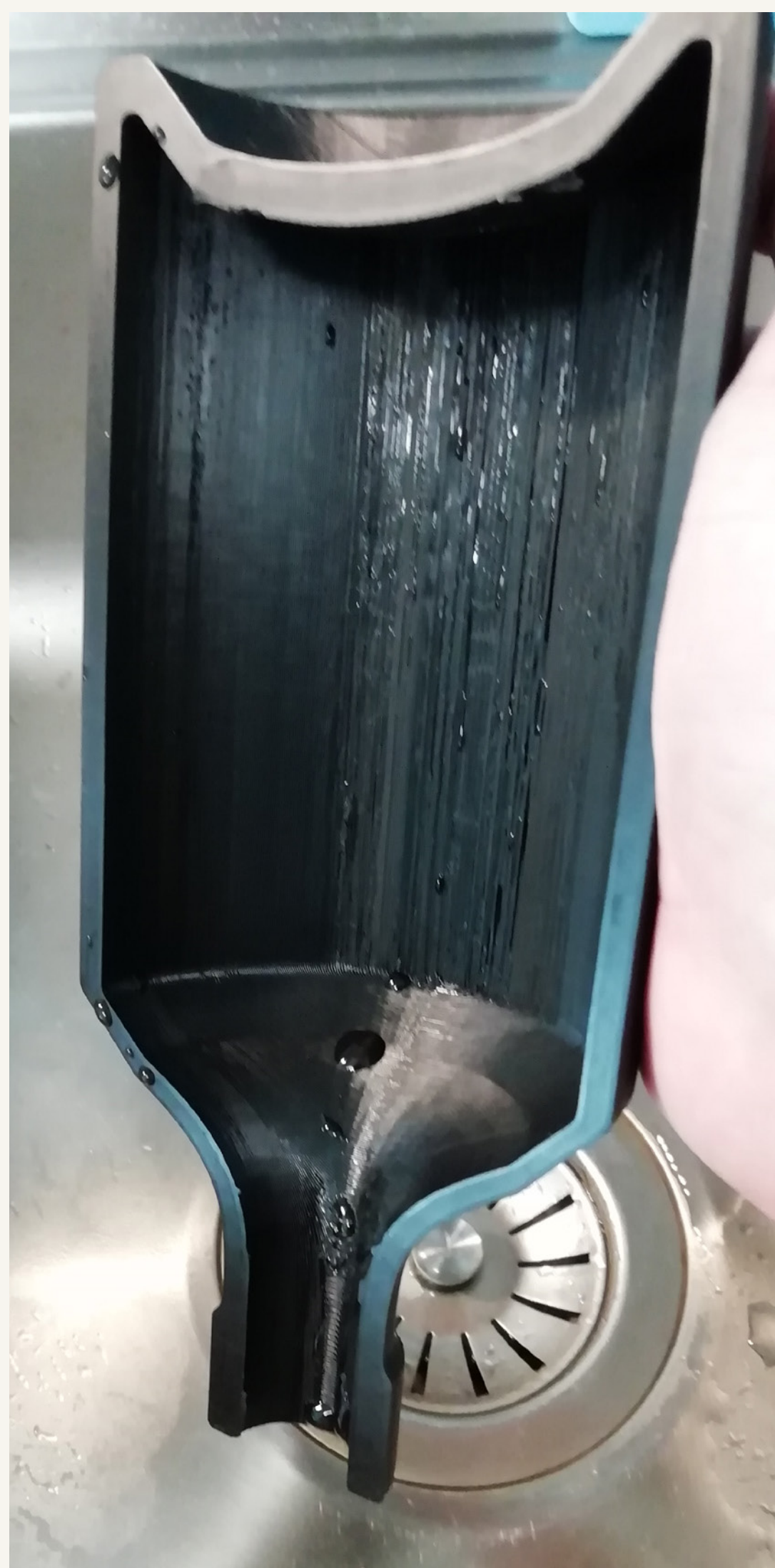
Kuva 42. Nesteen kerääntyminen pullon hartiaan
