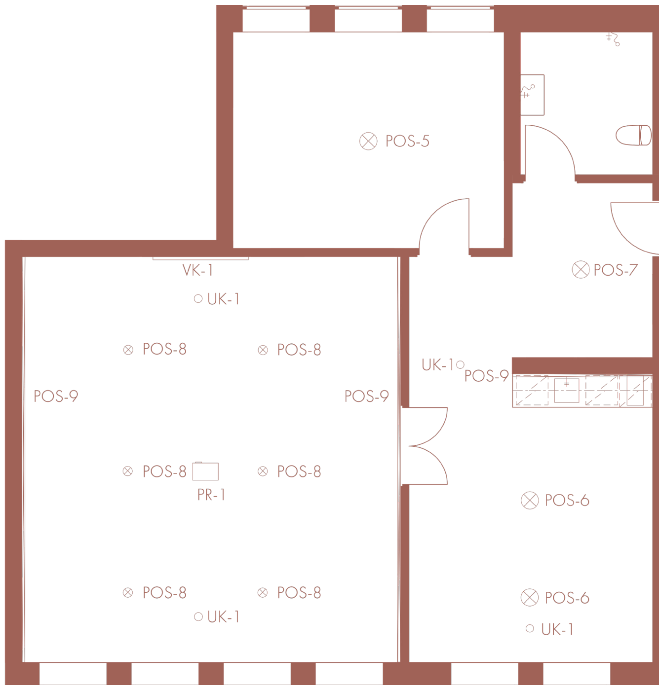
Kuva 141. Valaistuksen ja muun elektroniikan pohjapiirros.
