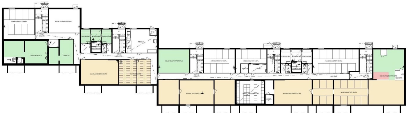
KUVA 19. B-talon pohjakuva, jossa on esitetty uusien asuntojen sijainnit keltaisella, yhteistilojen muutokset vihreällä sekä uuden käytävät punaisella. (Teivaala 2022)
