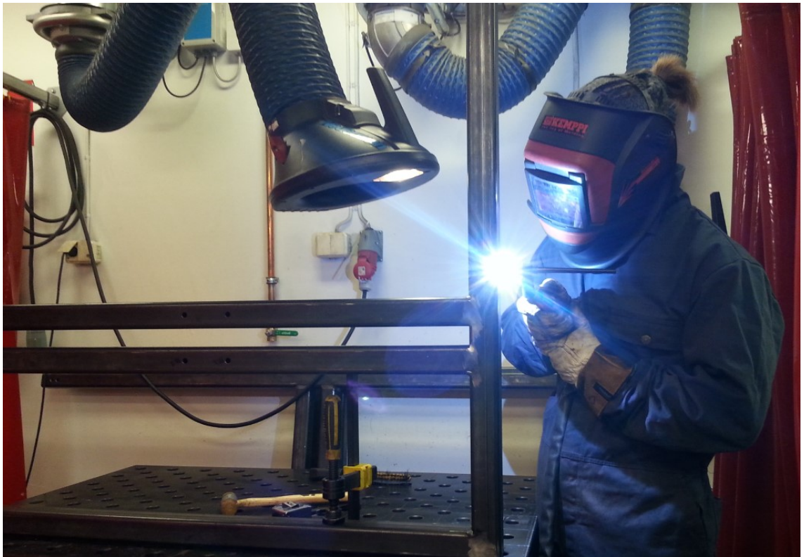
KUVA 11. Opinnäytteen tekijä hitsaamassa konenaulakon runkoa (Heikki Niva, 2015)
