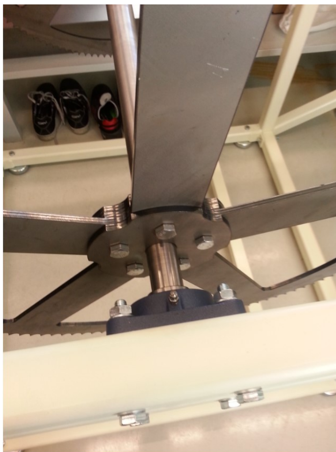
KUVA 18. Lähikuvassa ala-akselin, laakerin ja rungon kiinnityskohta (Heikki Niva, 2015)
