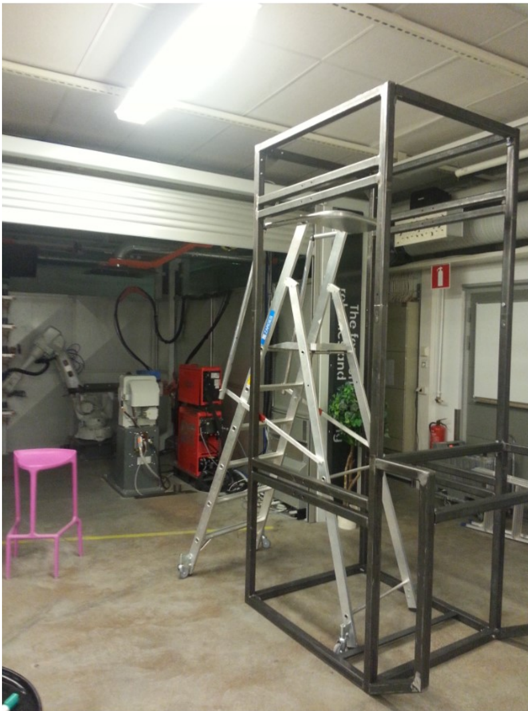
KUVA 13. Konenaulakon onnistunut testikokoonpano (Heikki Niva, 2015)
