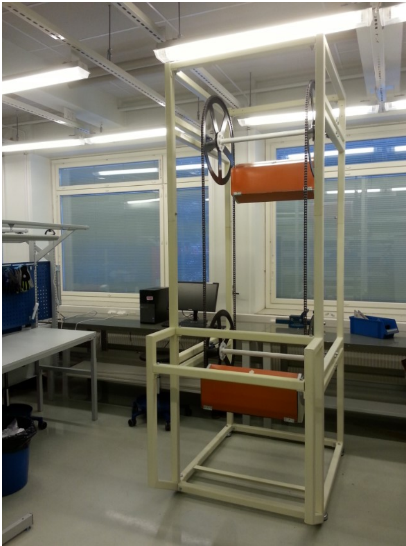
KUVA 20. Konenaulakon valmis prototyyppi (Heikki Niva, 2015)
