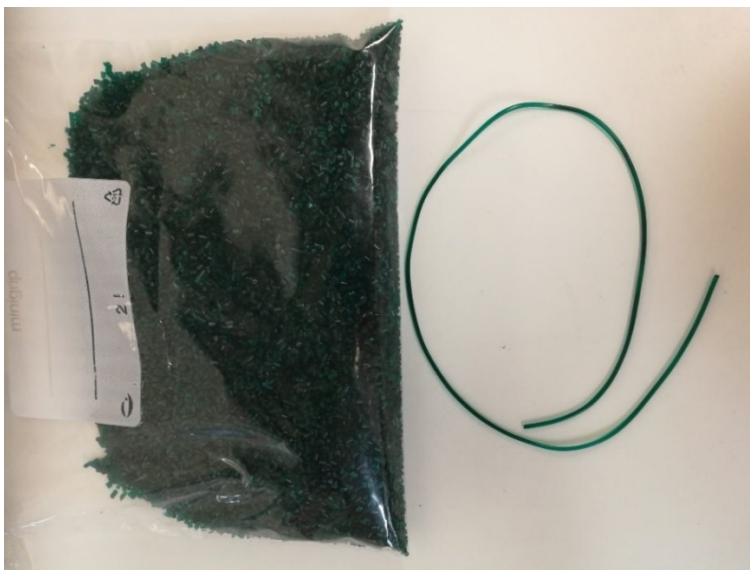
Kuva 6. Suoraan tuotannosta kerätystä PVB-muovista valmistettua filamenttia ja granulaattia. Ekstruusiolla valmistettiin filamenttia, joka granuloitiin pieniksi paloiksi.
