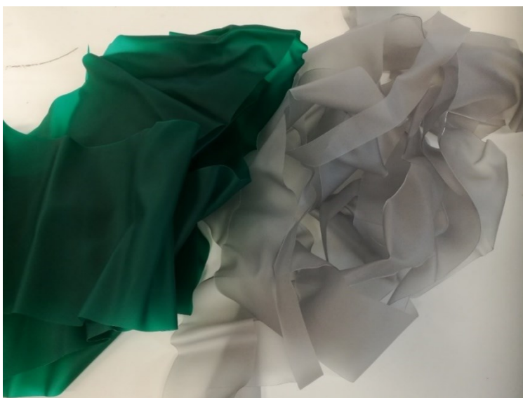
Kuva 4. Tuotannosta kerättyä puhdasta PVB-muovin ylijäämämateriaalia.
