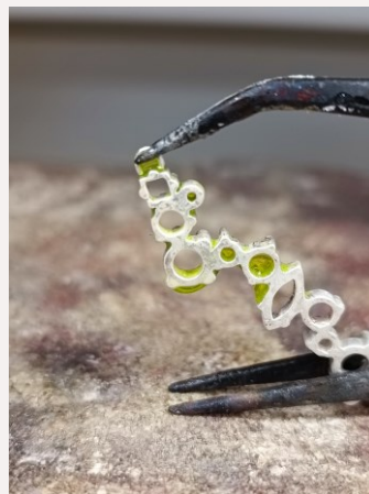
Kuva 90. Koru pitää suojata ennen juottamisen alkua. (Rantanen 2022)
