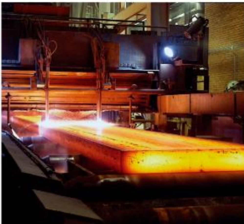
Kuva 2. Aihioin leikkaaminen polttoleikkauksella. (KUVA: Metallin jalostajat ry) (4.)
