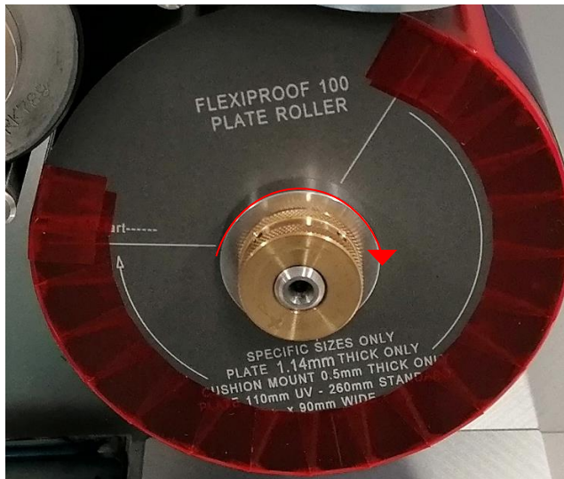
KUVA 14. Painotelan kiinnitysmutterin avausuunta
