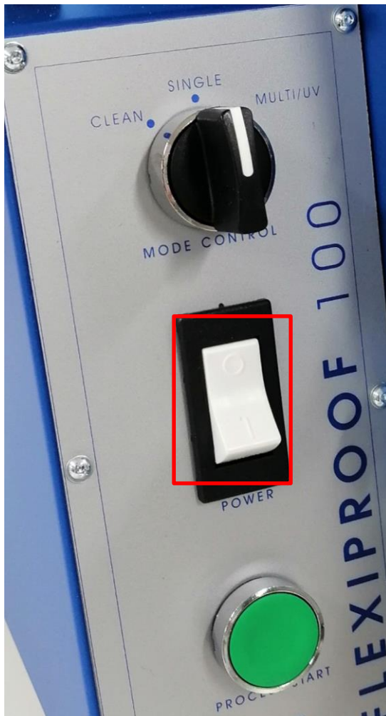
KUVA 1. FlexiProof 100:n käynnistyskytkin
