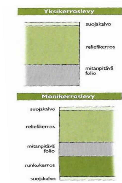
KUVIO 7. Yksi- ja monikerroslevyjen rakenteet (Ristimäki, Spännäri & Viluksela 2010, 78)
