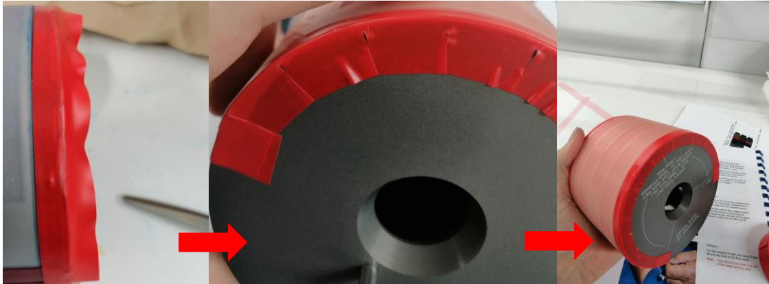
KUVA 24. Painolaatan teippaus (vasen), siivujen painelu telan sivulle ja valmis teippaus
