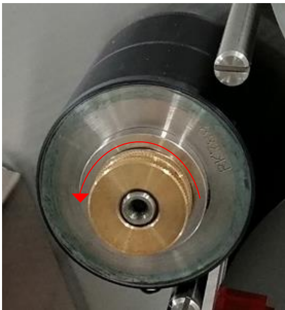
KUVA 18. Anilox-telan kiinnitysmutterin avaussuunta
