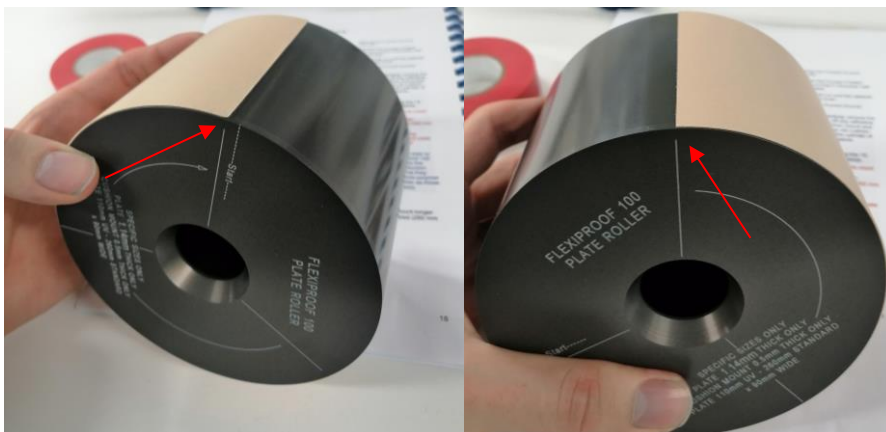
KUVA 21. Leikattu painolaatan pehmuste paikallaan
