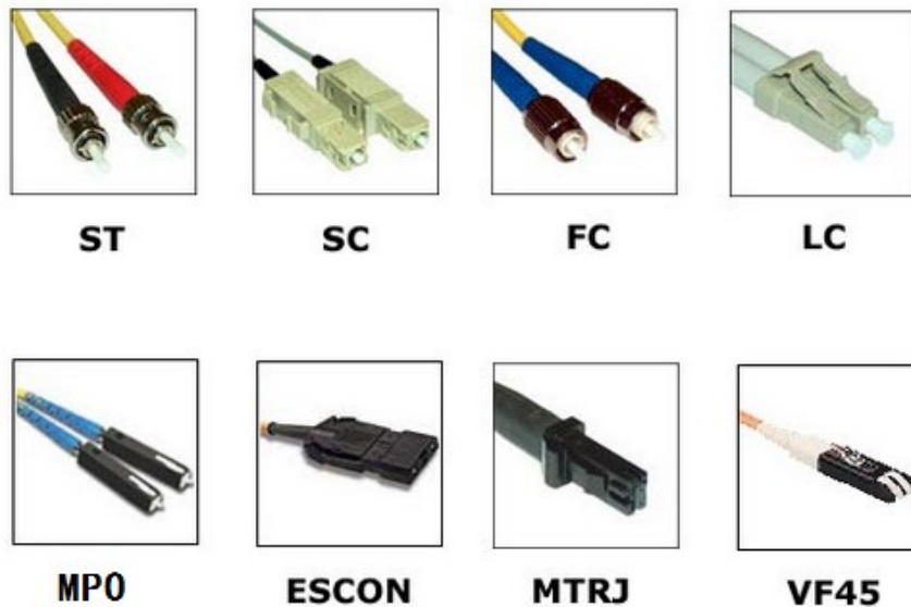
KUVA 9. Erilaisia valokuitukaapelin liittintyyppejä (Fife College 2022)
