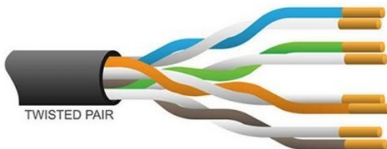
KUVA 12. Kierretty parikaapeli (Bolein 2017)
