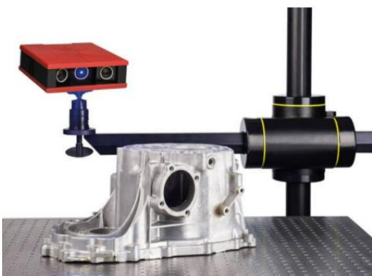
KUVA 6. Gom ATOS Core -skanneri, jollainen on käytössä myös Proventialla (17)
