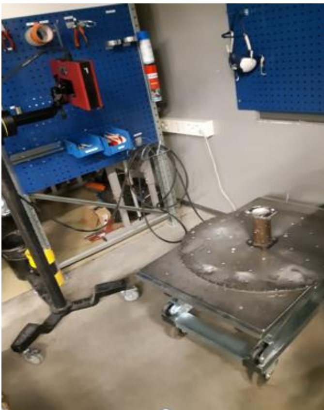
KUVA 10. Proventian 3D-mittauspaikka Quality-osastolla, kuvassa vasemmalla skanneri ja oikealla mittauspöytänä käytettävä pyöröpöytä, jossa on voimakkailla magneeteilla kiinnitetty mittausjigi, jigissä ja pöydässä on valmiina referenssipisteitä
