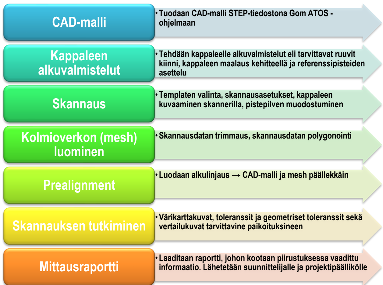
KUVA 11. Yleinen 3D-skannausprossi Gom ATOS -järjestelmällä
