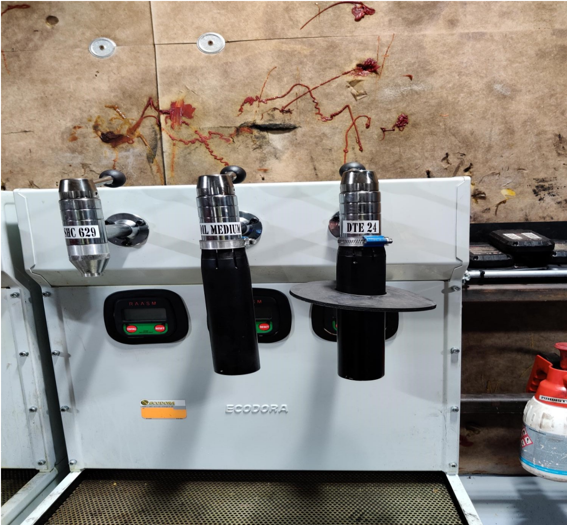
Kuva 5: Letkun asennus öljybaarin hanoihin
