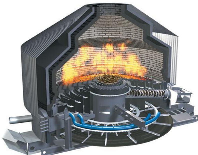
Kuva 3. BioGrate kosteiden polttoaineiden arinapoltin. (Ympäristö www-sivut 2021.)
