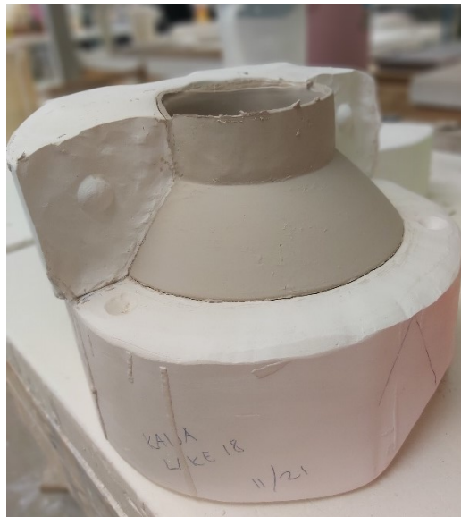
Kuva 5. Valun jälkeen avattu alfabrototyyppin muotti
