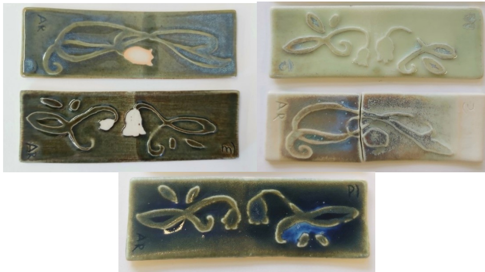
Kuva 17. Sellakkakoristekokeet neljällä eri lasitteella: uusi WKL (vasemmalla yllä), P30/18 (vasemmalla alla), WKL-kuparilasite (oikealla yllä ja alla), WKL-rautalasite (keskellä alla)
