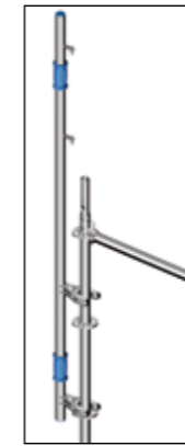
Kuva 32 Asennuskaiteen kiinnitys telineen pystyputkeen.
