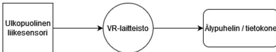
Kaavio 2. Kerätty data siirtyy ensin VR-laitteistoon, joka siirtää sen data-analyysissä käytettävään laitteistoon.
