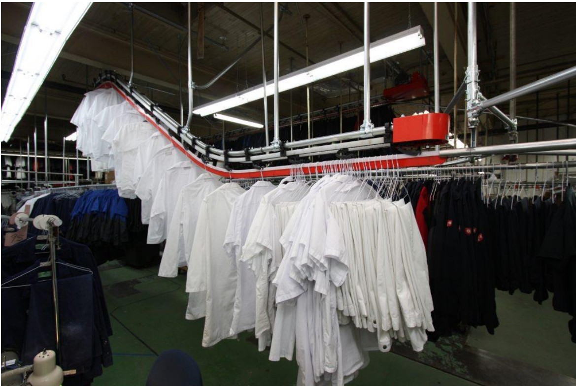
Kuvio 8: Moottorisoitu vaatteiden säilytysjärjestelmä (A2B Clip and pin conveyors n.d.)
