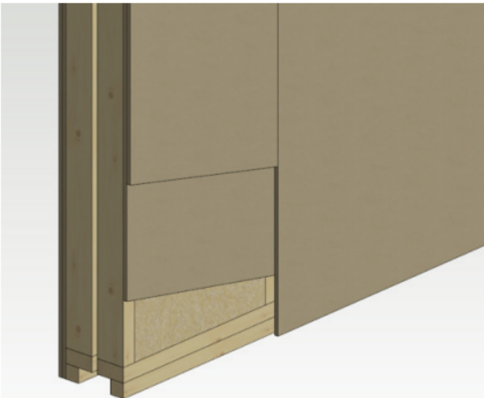
Kuvio 5. Havainnekuva huoneiston välisen seinän elementin rakenteesta
