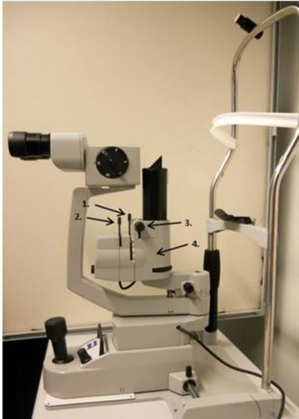
Kuvio 5. Zeissin mikroskoopi ja sen perussäädöt valonlähteen ollessa alhaalla (Ketola ym. 2014).
