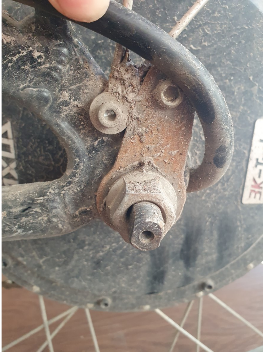
Kuva 15. Napamoottorin akseli ja niin sanottu torque arm.
