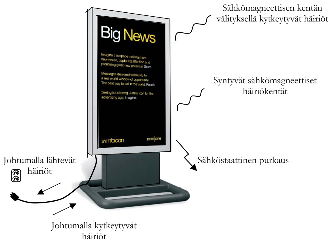
Kuva 4. Sähkömagneettisten häiriöiden leviäminen.
