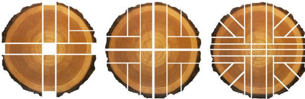
Kuva 8. Esimerkki kvarttisahaustuksesta. (Puuproffa 2022.)
