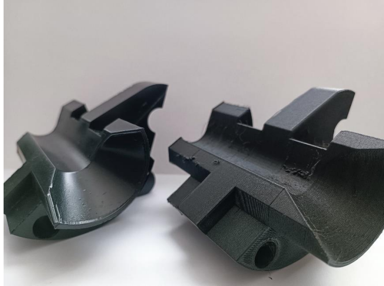
Kuva 25. Alkuperäinen varaosa (vasen) ja 3D-tulostettu varaosa (oikea)
