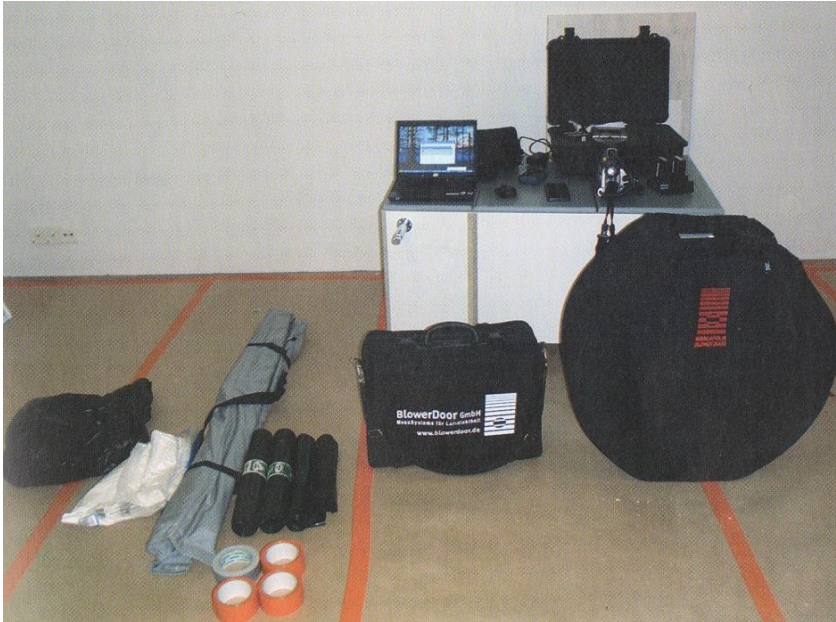
KUVA 4. Minneapolis-tiiviysmittauslaitteisto sisältöineen (Paloniitty 2012, 33)
