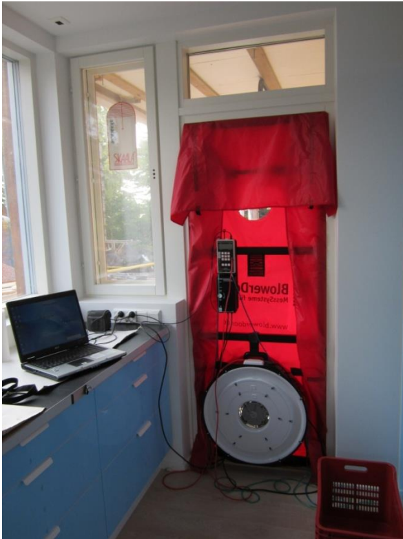
KUVA 4. Minneapolis-tiiviysmittauslaitteisto sisältöineen (Paloniitty 2012, 33)
