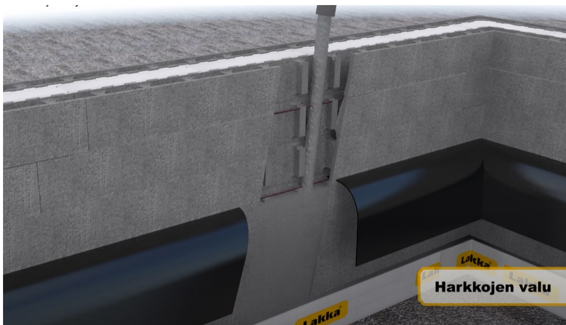
Kuva 4. Havainnollistavassa videossa näkyy kuinka betoni täyttää eristemuotti- harkkoseinän kuoren (Lakka – Lakka konserni 2016).
