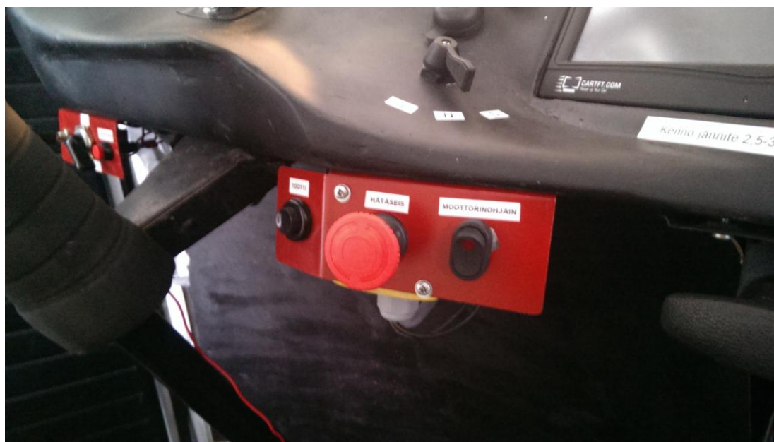
Kuva 8. Hätä-seis-painike S0.1 kojelaudassa
