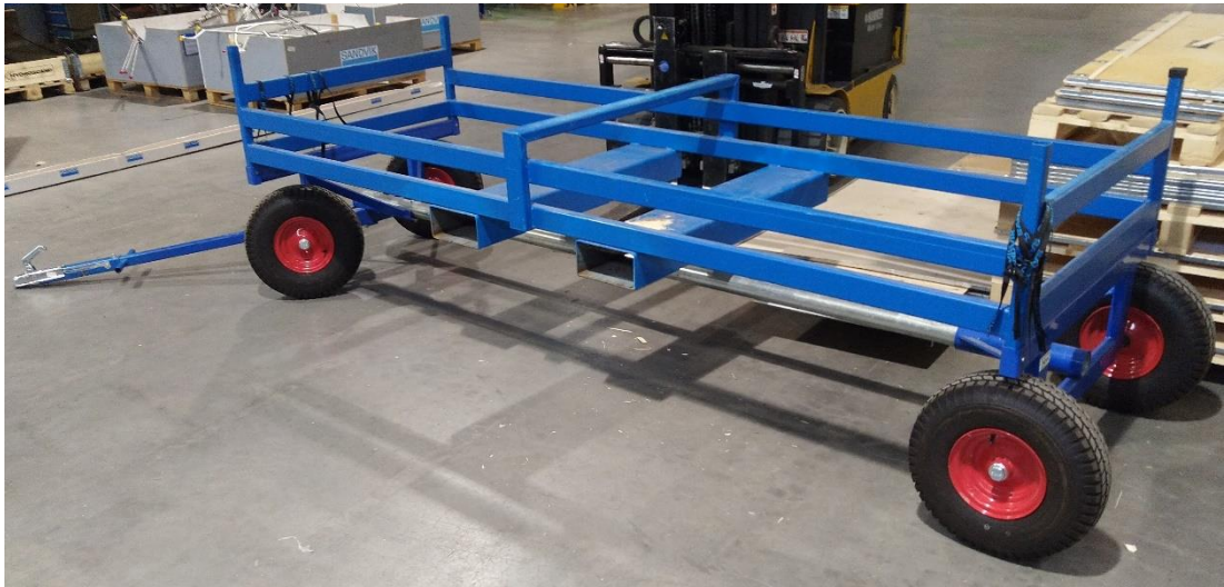
Kuva 4. Raakaputken kuljetukseen käytettävä kärry
